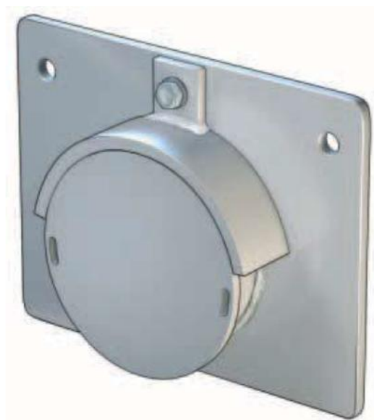
Рис.9 Устройство подвеса УЭ из синтетических нитей
